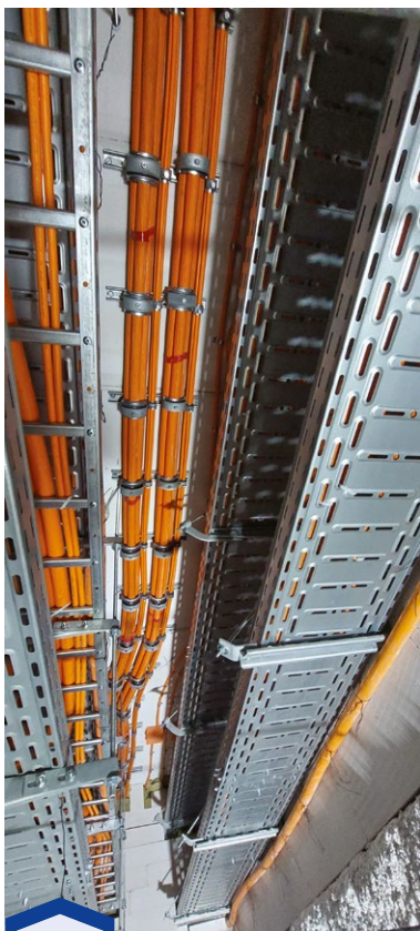
Zespół tras kablowych przed badaniem E90 wg DIN 4102-12
