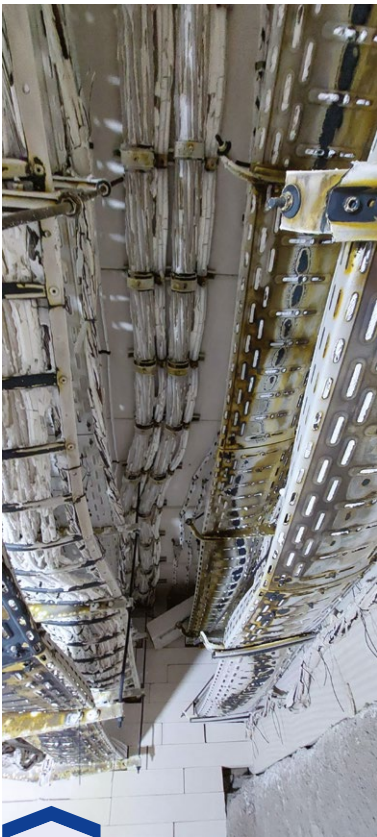
Zespół tras kablowych po badaniu E90 wg DIN 4102-12
