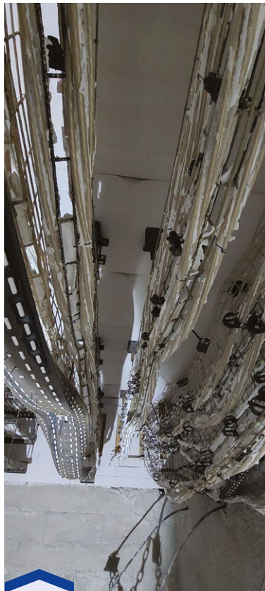
Zespół tras kablowych po badaniu E90 wg DIN 4102-12
